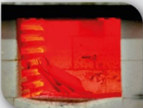
Forno para TRATAMENTO TÉRMICO
